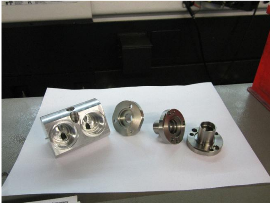
Pièces exemples, programmées à l'aide de GibbsCAM sur le Mazak Integrex de Pomtava
