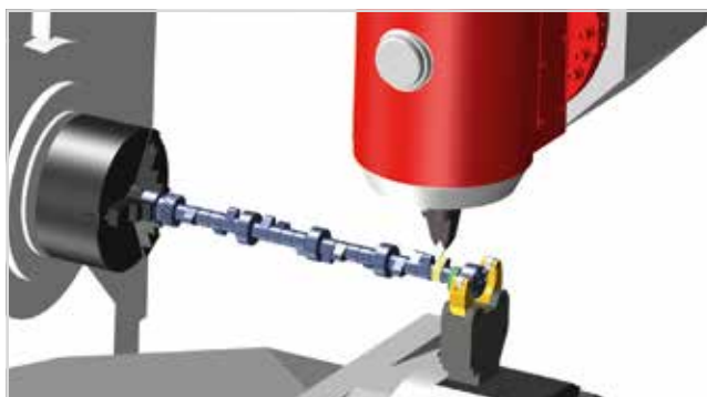
Nouvelle fonctionnalité du logiciel de FAO GibbsCAM, le tournage excentrique permet de créer des opérations sur des formes non alignées avec l'axe central de la pièce.
